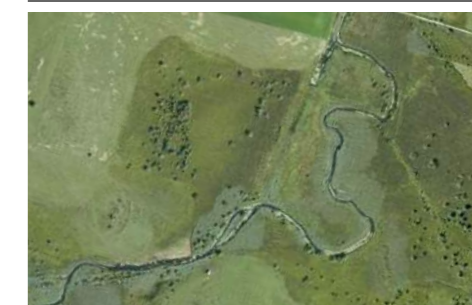
Vue aérienne du Dugeon reméandré à Houtaud (25). L'ancien lit rectifié est encore bien visible à l'ouest des deux méandres (Source ©IGN-BDOrtho2015).
