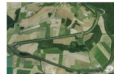
La vallée de la Saône à proximité de Gray (70), où les aménagements pour la navigation sont visibles, comme le méandre coupé par un canal ou le barrage (Source ©IGN-BDOrtho2015).
